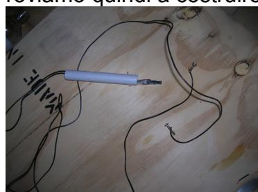
Per farlo ho semplicemente utilizzato un tubo di plastica di sezione leggermente maggiore del generatore, che vi ho infilato dentro, e cosparso di nastro adesivo in modo da fissarlo.
